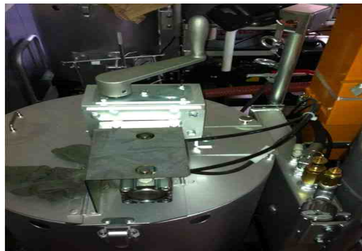
[사진 2] 소형 Motor 장착 교반기
